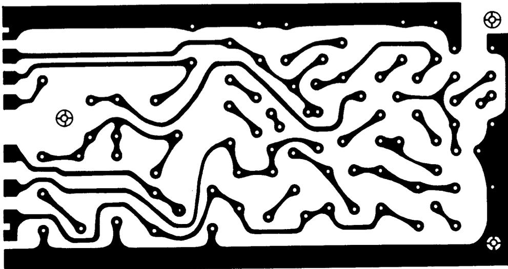
PLACA DE CIRCUITO IMPRESSO DO MÓDULO DE 70 WATTS - FIG.12 DA PÁG. 9
