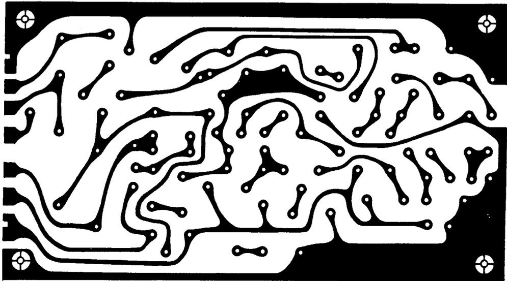
PLACA DE CIRCUITO IMPRESSO DO MÓDULO DE **130 WATTS** - FIG.16 PÁG. 13
