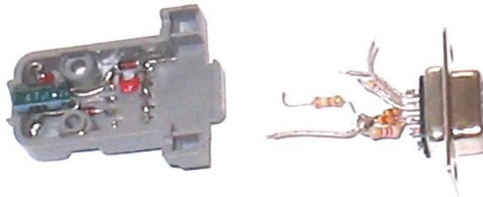
3-) Utilize agora fios flexíveis para fazer a ligação dos dois circuitos: Uma o pino 5 do soquete à massa do circuito da capa, o pino 8 do soquete ao pino 5 do terminal da EEPROM, a ponta livre do resistor de 4k7 ao pino 6 da EEPROM e o resistor de 390R ao anodo do LED. Pronto, a montagem esta terminada.
